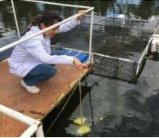
**Anexo 1.** Medición de turbidez del agua mediante disco de Secchi.
