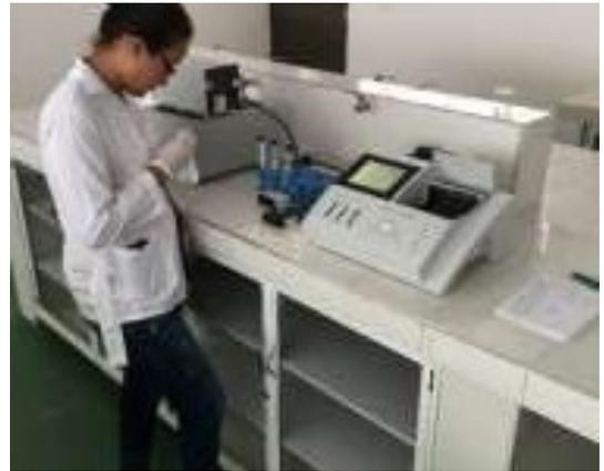
**Anexo 4.** Determinación de clorofila a mediante espectrofotómetro.
