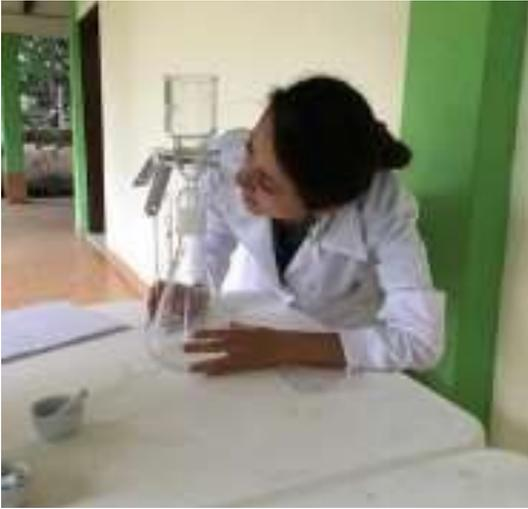
**Anexo 5.** Filtración de muestra de agua para análisis de clorofila a.
