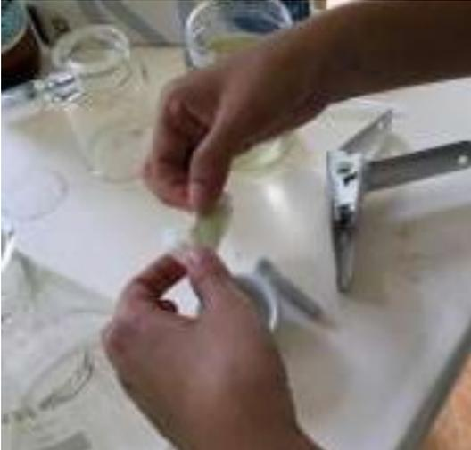
**Anexo 6.** Trituración de papel filtro para la medición de clorofila a.
