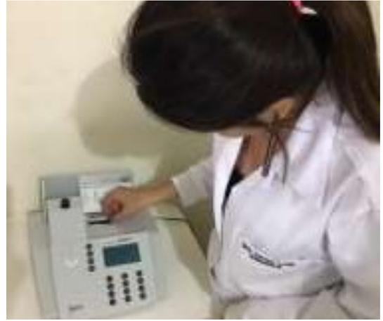
**Anexo 3.** Medición de parámetros químicos mediante fotómetro Spectroquant Nova 60.
