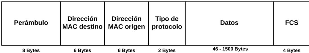
Figura 2. Formato de Trama Ethernet. Fuente: [4]
